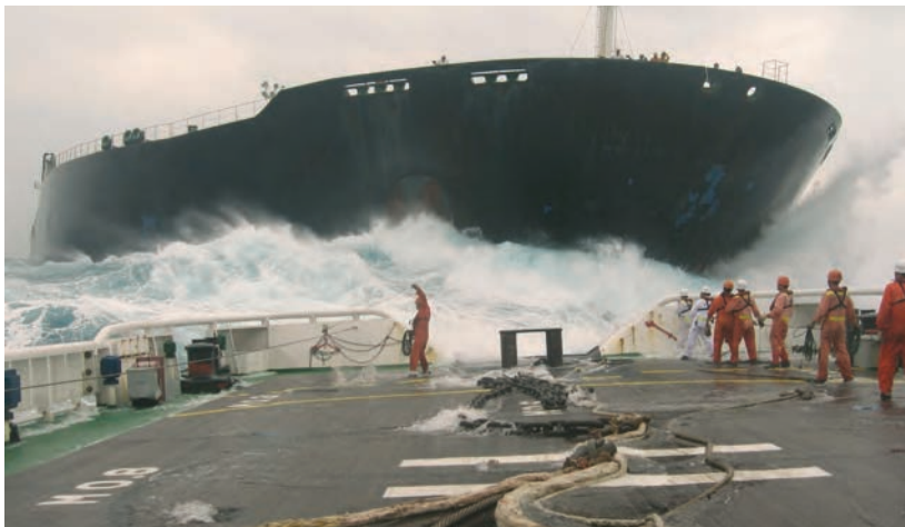
شکل ۵- پاره شدن طناب یدک کشتی بر اثر نیروهای حاصل از امواج اقیانوس
