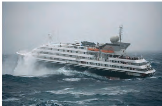
شکل ۸- شناوری که حالت Slamming برای آن اتفاق افتاده
