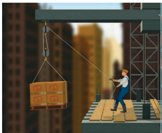
شکل ۲۶- ترکیب دو قرقه برای افزایش بهره مکانیکی
